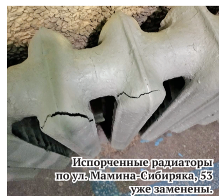
Лёд в системе отопления – причина лопнувших батарей.
